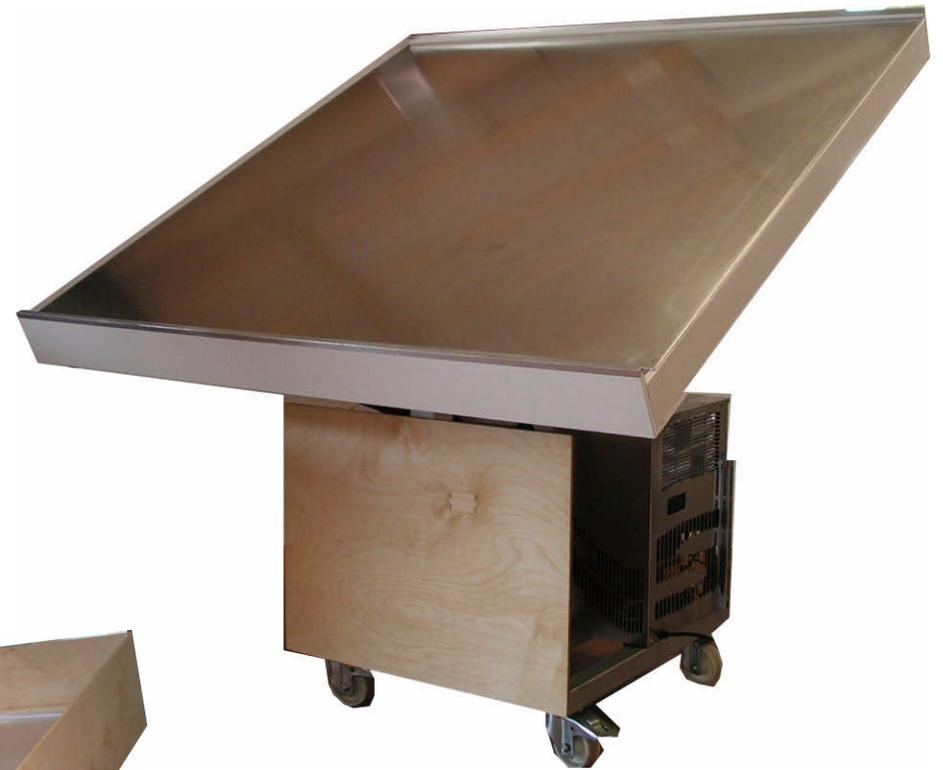
Einstellbare Neigung 0 bis  $\sim 30^\circ$  - einstellbare Höhe (5 x 50 mm) – auf Rollen mobil – Kühlfläche 1200 x 1210 mm (B/T) – mit Kaltwassersatz fest montiert. Optional die abgebildete Frontverkleidung! Optional der Wärmeschutzrahmen in gewünschter Höhe!
